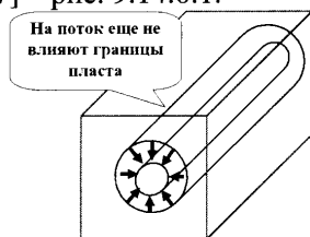
Рис. 9.14.0.1. Горизонтальная скважина, ранний радиальный режим течения в пласте
