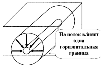
Рис. 9.14.0.2. Горизонтальная скважина, полурadiaльный режим течения в пласте
